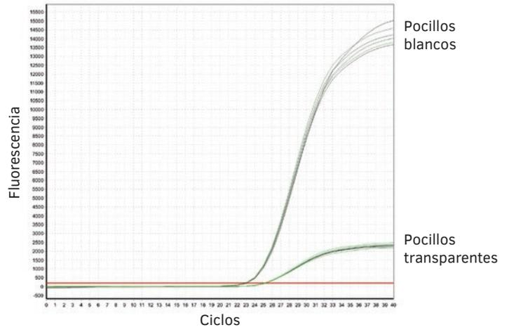
**Fig. 1:** Comparación de la fluorescencia de los artículos 72.985.002 (transparente) y 72.985.092 (blanco), obturados con la tira de tapas altamente transparente 65.989.002. Se amplificó un fragmento de 100 bp del plásmido EmGFP (cantidad de plantilla: 1.000 moléculas) en un volumen de 20  $\mu$ l con el termociclador Eppendorf realplex 4S (n = 8).
